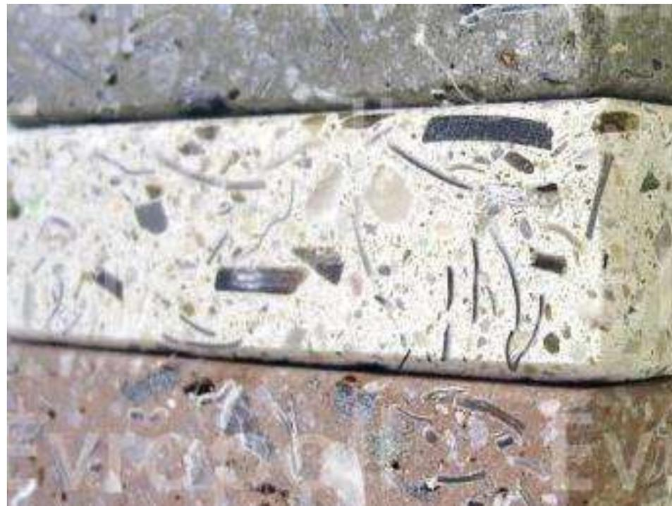
Армирование бетона композитной
